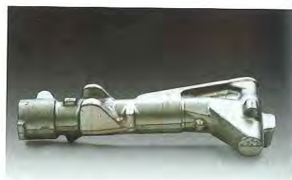
Exemple de pièce matricée : caisson train d'atterrissage
