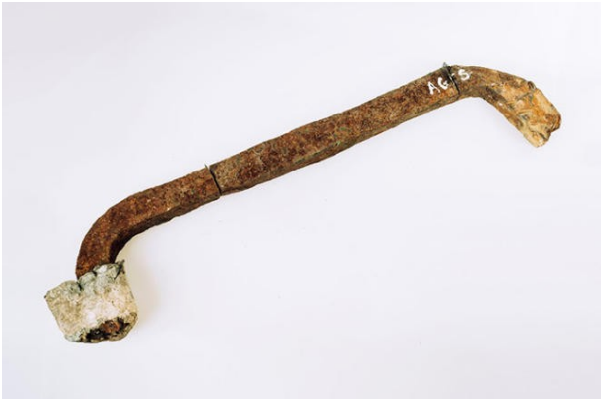
Agrafe provenant du chantier de Notre-Dame de Paris, après son découpage en vue d'une analyse métallographique. CYRIL
